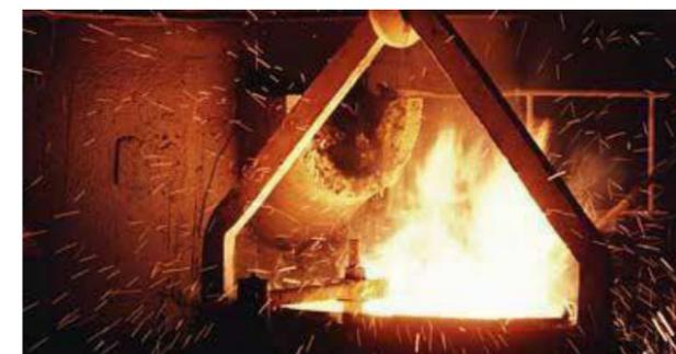
(Fuente: Fundiciones de HSE: folleto gratuito 2008 - Reproducido bajo los términos de uso de la licencia) Figura 9.3 - Horno de fundición
